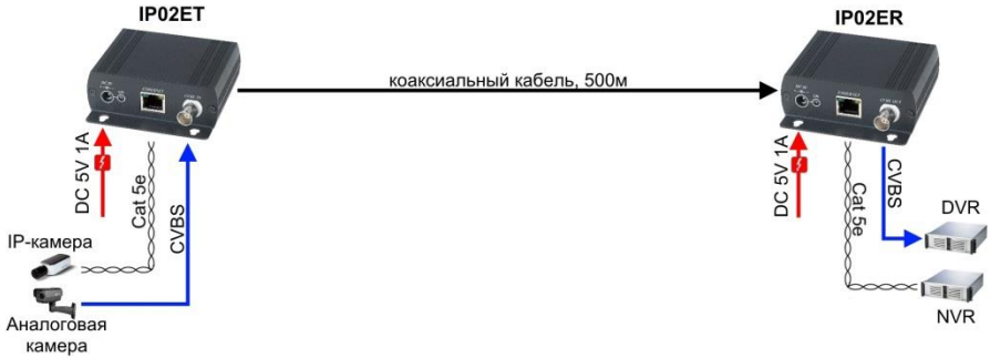
Рис.3 Схема подключения комплекта IP02E
